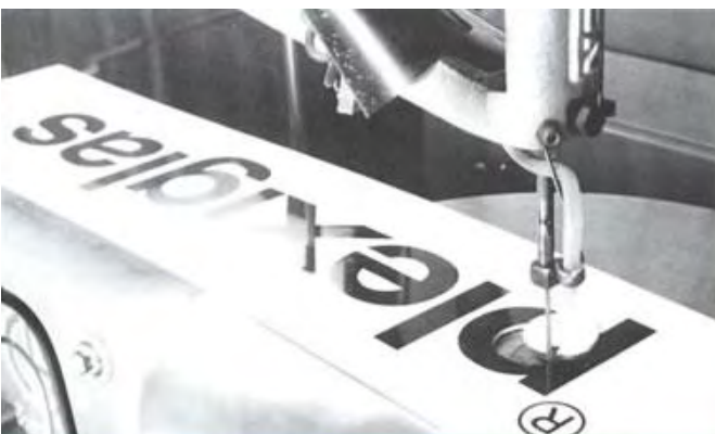
Рисунок 9 - Выпиливание лобзиком логотипа PLEXIGLAS
