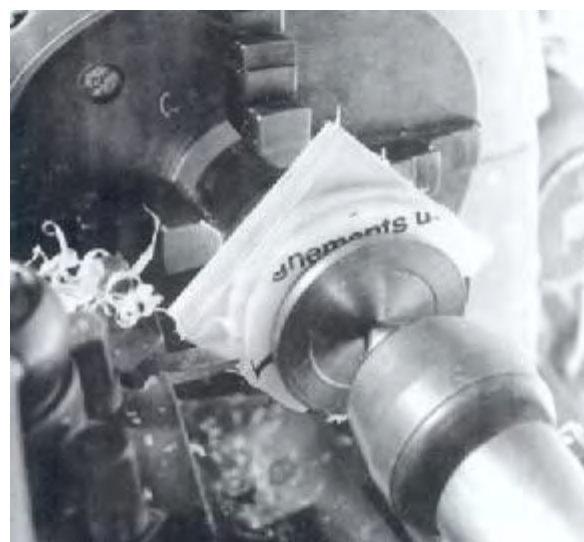
Рисунок 30 - Формирование дисков из стопки болванок между патроном и задней бабкой
