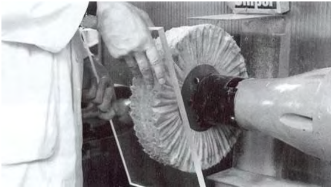
Рисунок 40 - Полировка матерчатым полировальным кругом
