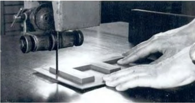
Рисунок 7 – Обрезка края при помощи ленточной пилы
