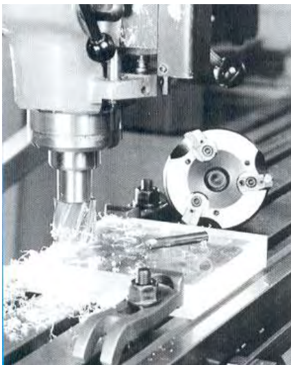
Рисунок 24 - Фрезерование PLEXIGLAS торцевой фрезой; различные другие типы фрез: (а) двух- кромочная фреза; (b) цилиндрическая фреза; (с) алмазная фреза
